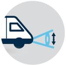
**7. Con el vehículo cargado, también se verá afectada la altura de los faros, por lo que se deberá reglar de nuevo su altura al utilizar las luces.**
